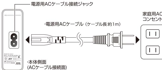
・本製品の電源用ACケーブル接続ジャックに付属の電源用ACケーブルのメガネ型コネクタ部をしっかりと奥まで差し込みます。
