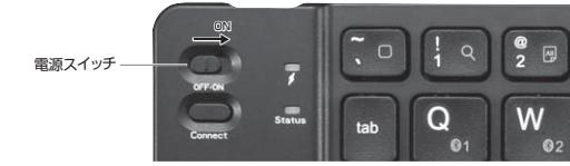
④fnキーとペアリング切替えボタンを同時に押してペアリングする番号を選択・決定します。ステータスLEDが早く点滅します。
