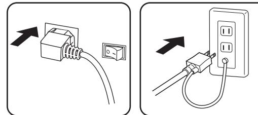
2. 背面の主电源スイッチの「-」を押し、主电源をONにします。
