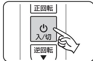
6. 「入/切」ボタンを押した後、必ず主電源スイッチの「OFF」を押し主電源をOFFにしてください。
