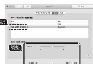
③「入力」から[400-BTMH013BK]を選択し音声入力の音量、バランスを調整します。
