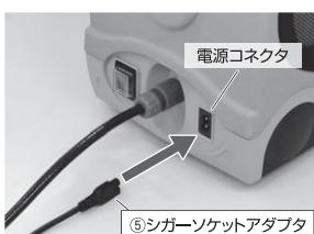
●シガーソケットアダプタのプラグをシガーソケットの奥に突き当たるまで差し込みます。
