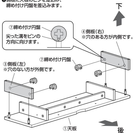
②締め付け円盤を回して固定します。
