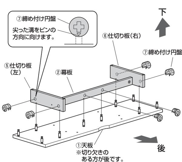
②締め付け円盤を回して固定します。
