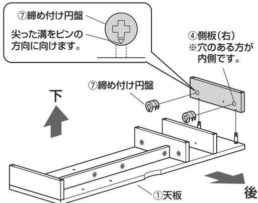
②締め付け円盤を回して固定します。
