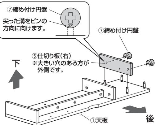
②締め付け円盤を回して固定します。
