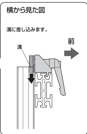
②アーム取付け用バーを水平にしてからレバーを回して固定します。
