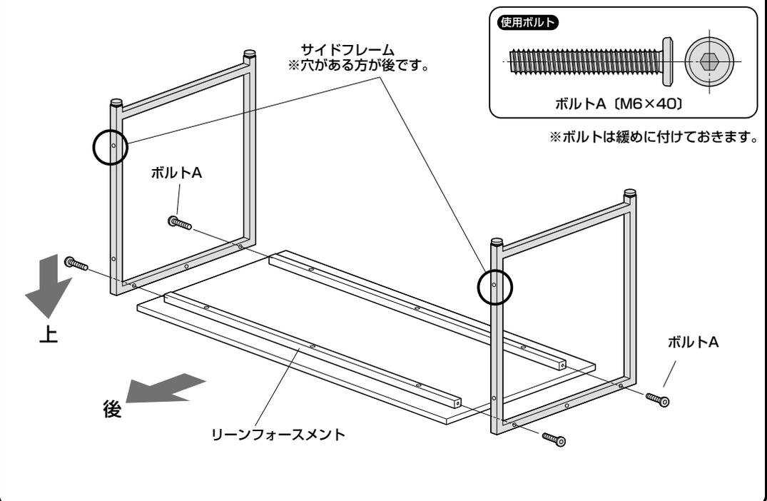
**4** サイドフレームにバックフレームを取付けて完成です。
